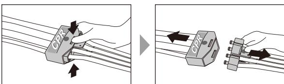
緊急でエアを抜きたいときにはマットに接続しているCPRユニットのジョイント部を外してください。体重・体型にもよりますが、約25秒間で、すばやくマット内のエアが抜け、心肺蘇生が行いやすくなります。
