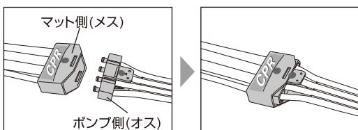
ポンプ、マットそれから出ているCPRユニットを接続してください。接続はワンタッチで簡単にできます。
